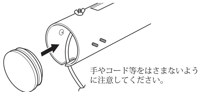
8. LEDユニットの電源コードに、付属の電源コードを接続します。
