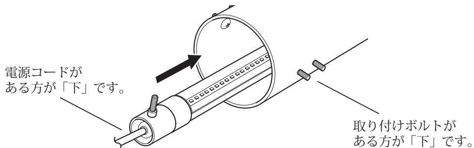
5. 上下ブラケットのネジ部を本体（パイプ）の穴に通し、蝶ねじBで固定します。
