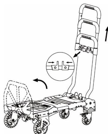
ロックレバーを押す事でハンドルの高さは3段階の調節ができます、好みの高さでハンドルをロックし、4輪台車として使用できます
