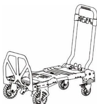
荷物が滑らないように、側面板を開いてください。長い荷物を運搬する際には、側面板を畳んだ状態での使用も可能ですが、運搬する荷物がはみ出したり落ちないように十分に注意しながら運搬をしてください。
